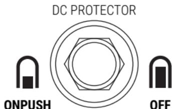
Der DC-Schutzschalter schaltet sich automatisch aus, wenn die angeschlossene Last die Nennleistung des Stromerzeugers überschreitet.
