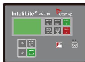
Unterstützt die Überwachung, Messung und den Schutz von Motoren und Generatoren. Dies ist eine Langzeit- und Backup-Einheit, um die beste Möglichkeit zur Steuerung zu integrieren. Unterstützt Modbus-Standard, Modem, RS232, RS485, USB und Internet.
